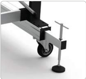
Base provista de estabilizadores extraíbles y husillos regulables para salvar hasta 26 cm de desniveles.
